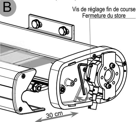
Déployer d'environ 30 centimètres et agir sur la vis haute d'un 1/2 tour vers le ⊕ à l'aide de la clé six pans N°4.
