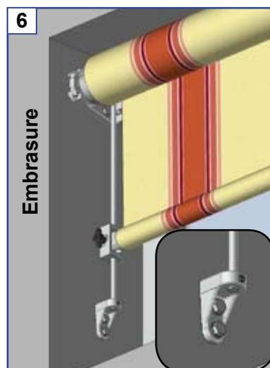
Fixation avec des vis Ø10mm. Kit de vis, cheville et rondelle non fournis.
