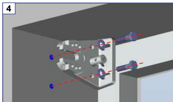
Fixation avec des vis  $\varnothing 10\text{mm}$ . Kit de vis, cheville et rondelle non fournis.
