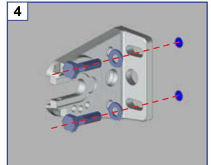
Fixation avec des vis  $\varnothing 10\text{mm}$ . Kit de vis, cheville et rondelle non fournis.
