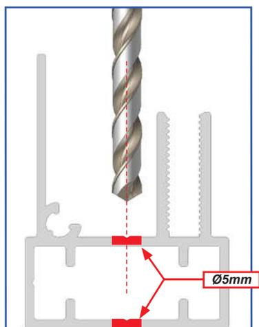
Fixation avec des vis Ø4.2mm.
