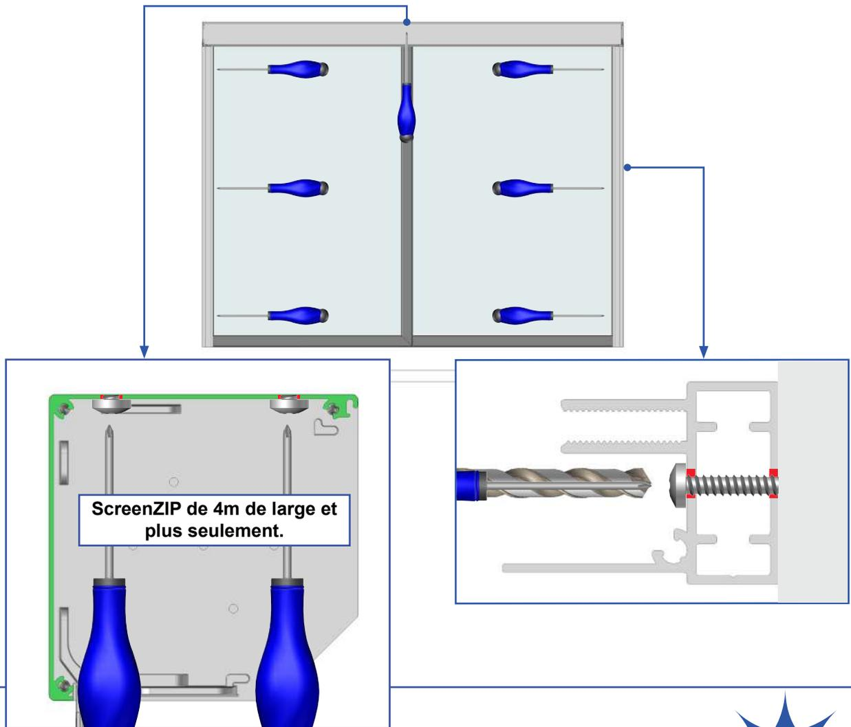
**7 Remonter le tube d'enroulement.**
