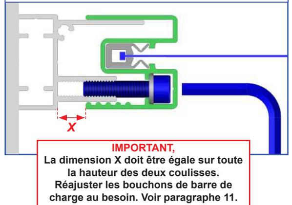
**16 Réaliser les fins de course ouverture et fermeture.**
